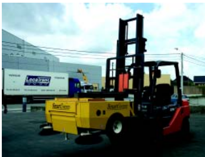
A SmartSweep é mecânica e opera acoplada no garfo de uma empilhadeira. Tem capacidade para 400 kg e pode ser utilizada tanto em pisos lisos como em chãos mais ásperos
