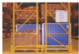
Guard Rail tubular com 300 mm de altura.
