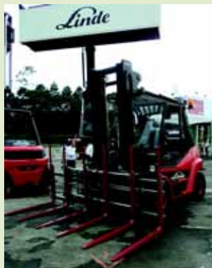
Máquina Linde com posicionador triplo de garfos, que objetiva otimizar a movimentação na indústria de bebidas, manuseando três paletes por operação
