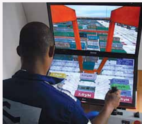
Equipamento permite simular a operação de guindastes de forma mais próxima da realidade
