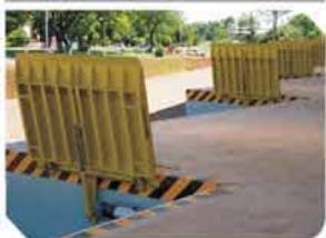
Niveladora avançada na doca
