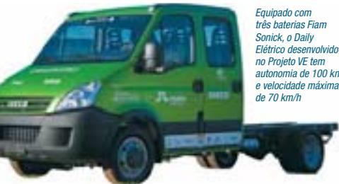
*Equipado com três baterias Fiam Sonnick, o Daily Elétrico desenvolvido no Projeto VE tem autonomia de 100 km e velocidade máxima de 70 km/h*
