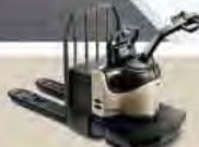
D Transporte Horizontal Carga e Descarga capacidade de seleção com variação a pé da empilhadeira.
