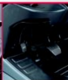
Freio de estacionamento acionado pelo pé
