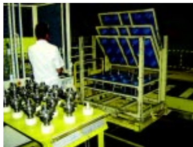
Rack que permite o acesso a todas as peças dentro do raio de alcance otimizado para o operador
