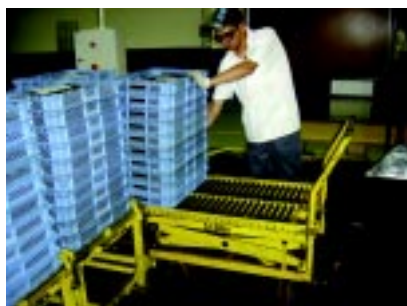
Na transferência de carga, o operador não precisa carregar as caixas, mas apenas deslizá-las
