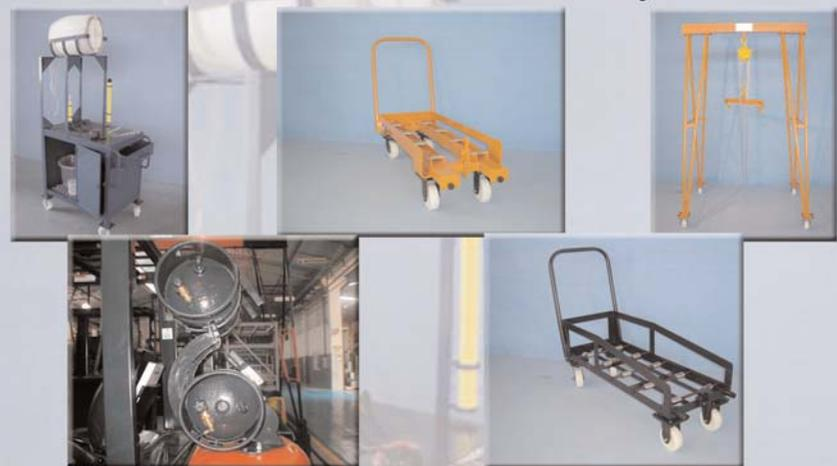
Carro, estrados e pórticos para retirada de baterias tracionárias /
