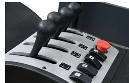
ma de amortecimento e ajuste, controles e alavancas de comando de fácil acesso e de alta ergonomia, motores de AC trifásicos para translação e elevação que não requerem manutenção, frenagem regenerativa eletrônica, evitando desgastes das partes mecânicas, e controle de velocidade preciso, com e sem carga, elevando e baixando.
