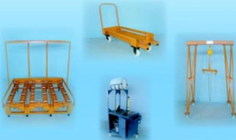
Carro, estrados e pórticos para retirada de baterias tracionárias
