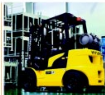
25L-7 Gás / Capacidade de carga: 2,500 Kg Tipo de Motor: Hyundai Beta Velocidade: 20,6 Km/h
