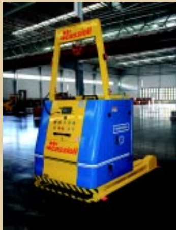
O LGV é guiado por um scanner laser instalado na parte superior do carro
