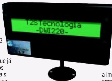
Aparelho é composto de display de cristal líquido e módulo wireless
