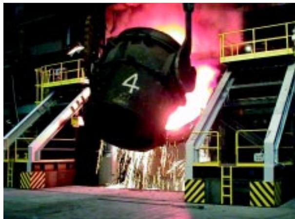
**Com a reforma, ponte rolante passou a operar com gusa líquida proveniente do alto-forno**
